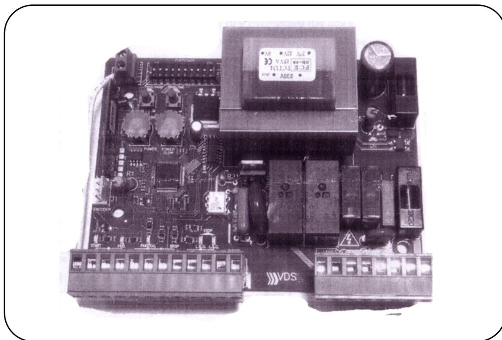
Apparecchiatura di comando 1 Motore 230Vac
