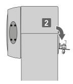
In caso di quasto o di mancanza di tensione, inserire e ruotare la chiave in senso antiorario, aprire completamente lo sportello. Aprire manualmente la barriera.
